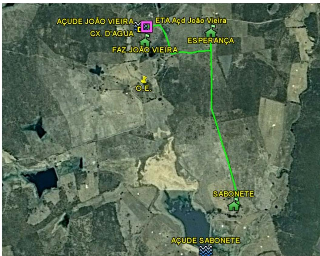
Figura 5.6: Esquema do sistema de abastecimento do sub-bloco 1.2.
