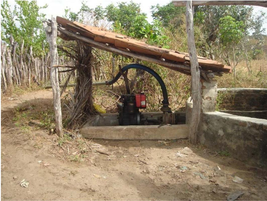
Figura5.29: Motor a diesel captando água no poço amazonas para irrigação.
