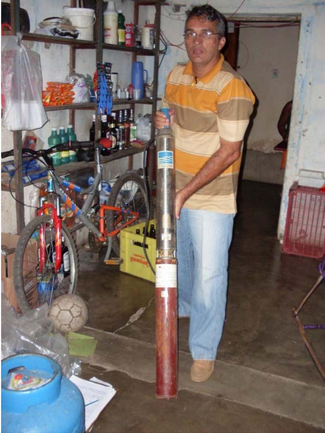
**Figura 4.21: Bomba submersa de poço aluvionar abandonado.**
